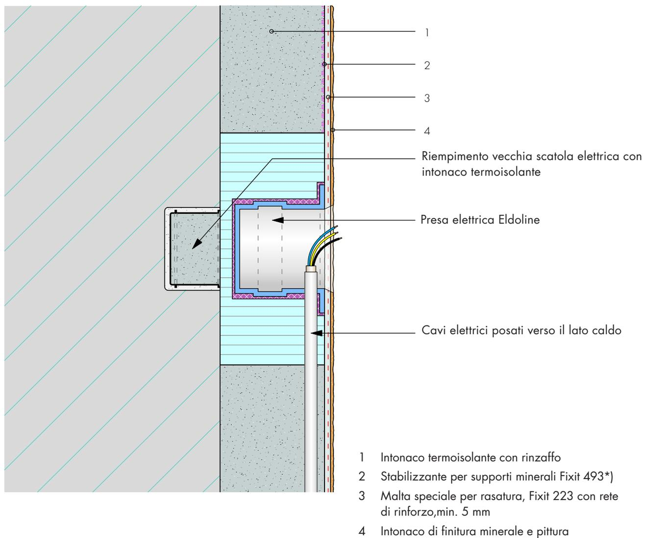
\*) Solo per intonaco Aerogel Fixit 222
