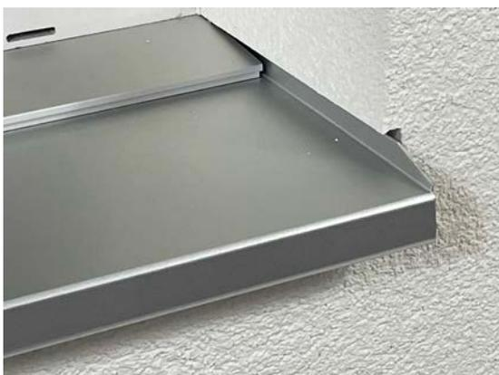
Mit dem Einbau des Sol-Pad Fenstersystems lässt sich ein unterhaltsfreundlicher Anschluss zwischen Fensterbank und Fassade realisieren. Durch die Entkoppelung von Fassade und Fensterbank entsteht ein wartungsfreier und schlagregensicherer seitlicher Anschluss. Thermischbedingte Längenänderungen der Fensterbänke werden durch die Entkoppelung problemlos und dauerhaft aufgenommen.
