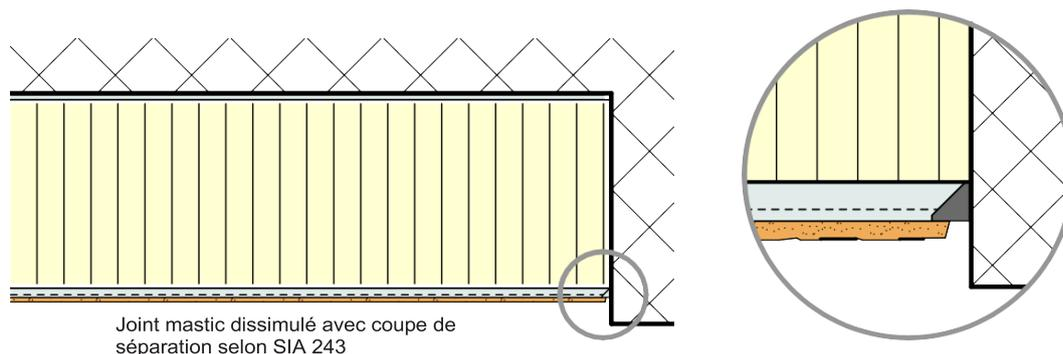
Joint mastic dissimulé avec coupe de séparation selon SIA 243
