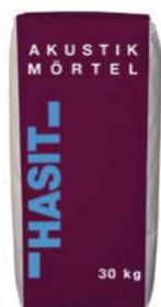
Einschichtiger und mehrschichtiger Kernputz, der speziell für das maschinelle Verputzen aller Arten von schalldämmenden Mauerwerkselementen in Innenräumen mit einer maximalen Schichtdicke von 25 mm entwickelt wurde. Die Schalldämmung der Grundwand wird um ein Sechstel verbessert, d.h. um ca. o 17%. Stark oder unterschiedlich saugende Untergründe müssen mit Vorspritz und Universalmörtel 610 behandelt werden.
