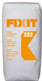
Innovativer, ökologischer, extrem wärmedämmender NHL-Aerogel-Putz für Neu- und Altbauten, für den Innen- und Außenbereich. Der Wärmedämmputz kann auf alle gängigen Untergründe, wie z. B. gebrannter Ziegel, Lochstein, Porenbeton- steine, Kalksandsteine usw. in einer einzigen Schichtdicke von bis zu 8 cm aufgetragen werden. Er bietet eine 2 bis 3-mal höhere Wärmedämmung als herkömmliche Wärmedämmputze. Er entspricht der EN 998-1.
