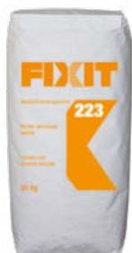
Mineralischer Armierungs- und Ausgleichsmörtel. Er dient zum Einbringen von Armierungsgewebe und damit zur Verstärkung von Fixit Aerogel – Wärmedämmmörtel. Das Produkt erfüllt die Anforderungen der Denkmalpflege. Bei Verwendung als Ausgleichsmörtel auf tragenden Untergründen muss der Untergrund matt feucht sein. Er entspricht der EN 998-1.
