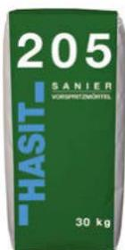
Sanier- Vorspritz der Druckfestigkeitskategorie CSIV speziell zum Verputzen vom feuchten und vom Salz belastenden Mauerwerk. Untergrundbehandlung, Adhäsionsschicht zum anschließenden Auftragen von Sanierputzen. Er ist Teil des Sanierungssystems gemäß der Richtlinie WTA 2-2-91.
