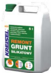
Mittel auf Wasserglasbasis für die Vorbereitung des Untergrundes vor dem Auftragen von Putz, Kitt, Gipsputzmassen und Anstrichen. Zum Festigen des Untergrundes, zur Begrenzung und zum Ausgleich der Wasseraufnahme ohne Verringerung der Dampfdurchlässigkeit. Ideal unter Silikatanstriche.
