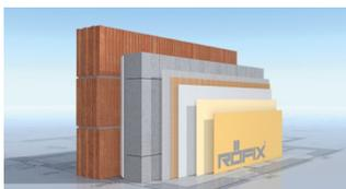
Il pannello isolante è componente omologato dei sistemi di isolamento termico a cappotto RÖFIX LIGHT und RÖFIX POLY con valutazione tecnica europea ETA secondo ETAG 004.
