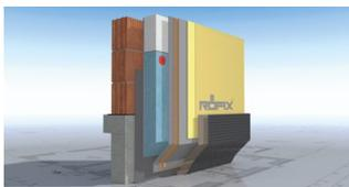
Il pannello isolante di zoccolatura è componente dei sistemi di isolamento termico a cappotto RÖFIX con valutazione tecnica europea ETA secondo ETAG 004.
