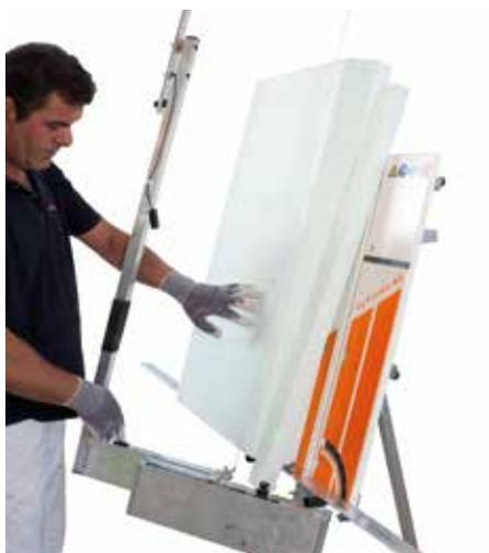
Schrägschnitt der Sockeldämmplatte in 45 Grad
